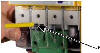
Den unteren gelben Verriegelungsschieber (C) mit einem Schraubendreher nach unten ziehen und ATICS® unten etwas anheben.
